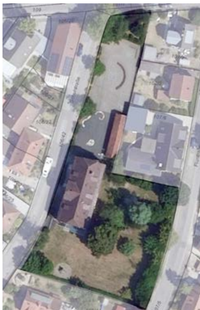
Quelle: Bayerische Vermessungsverwaltung // Die Luftaufnahme zeigt die Grundschule in Seubelsdorf. Anhand dieser Aufnahmen ermittelt ein Ingenieurbüro den Anteil der versiegelten und bebauten Fläche. Hier sind es 1002 Quadratmeter von insgesamt 2919 Quadratmetern Grundstücksfläche.
