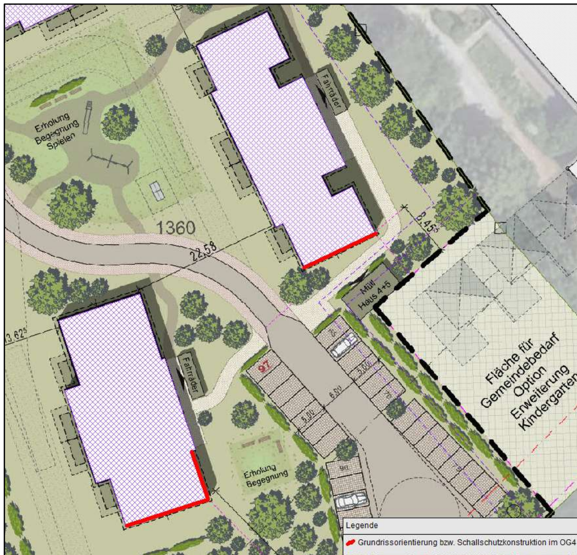
Abb. 8: Auszug Schalltechnische Untersuchung - Fassadenteile mit Handlungsbedarf
