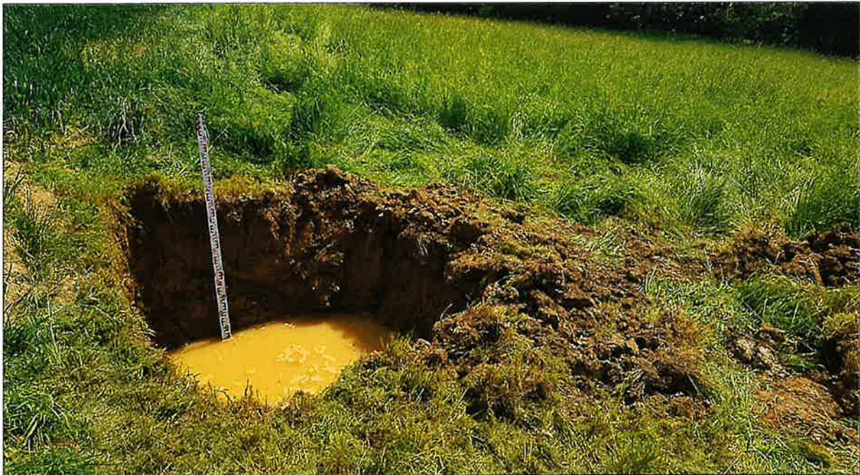
Abbildung 1: Versickerungsversuch 5 im südwestlichen Untersuchungsbereich, aufgenommen am 15.05.2024
