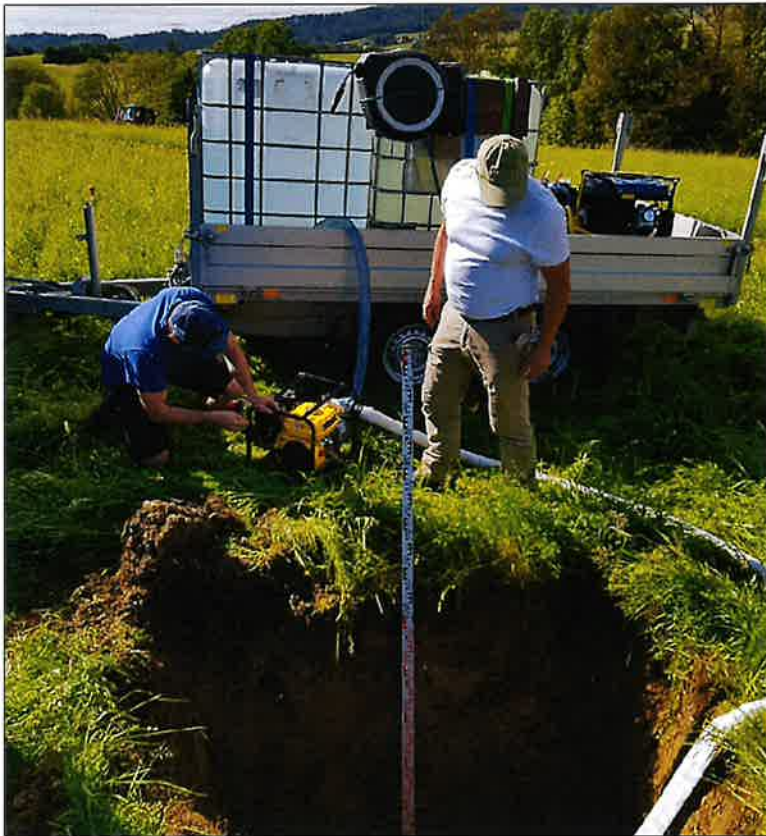
Bild 2: Füllprozess der Baggerschürfe mit Wasser beim Versickerungsversuch 1
