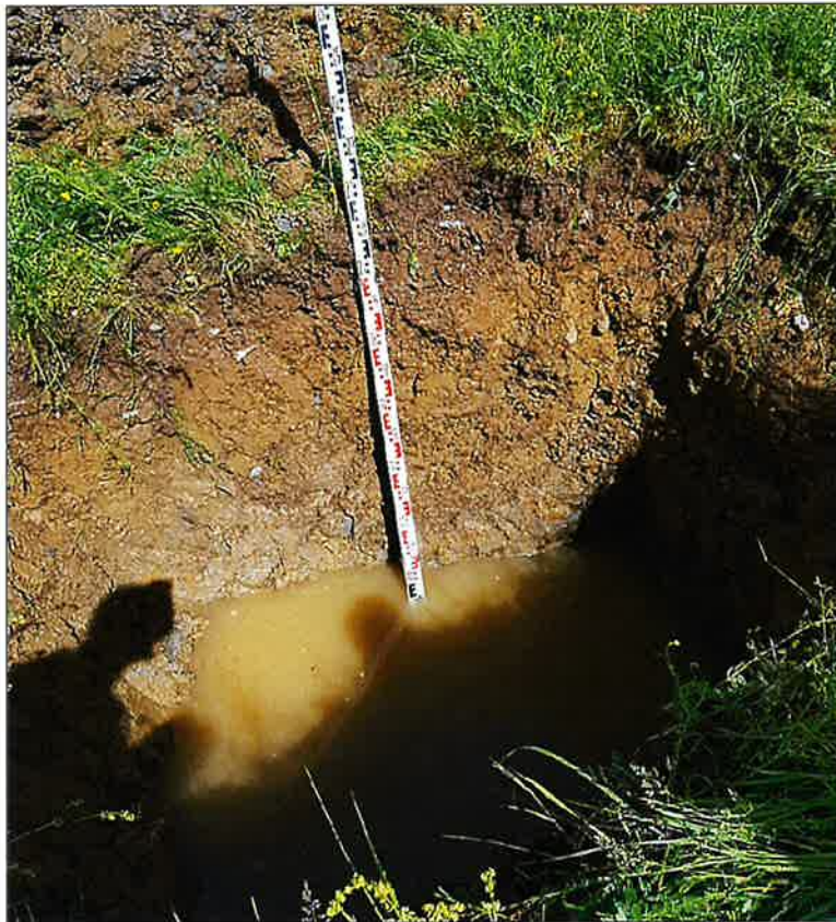
Bild 3: Mit Wasser gefüllter Baggerschurf beim Versickerungsversuch 2.
